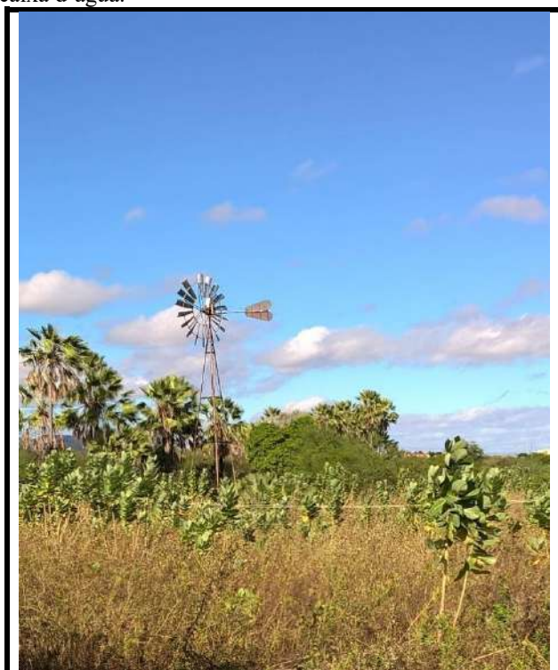
Figura 3.28- Cata-vento que bombeia água do poço para a caixa d'água.
