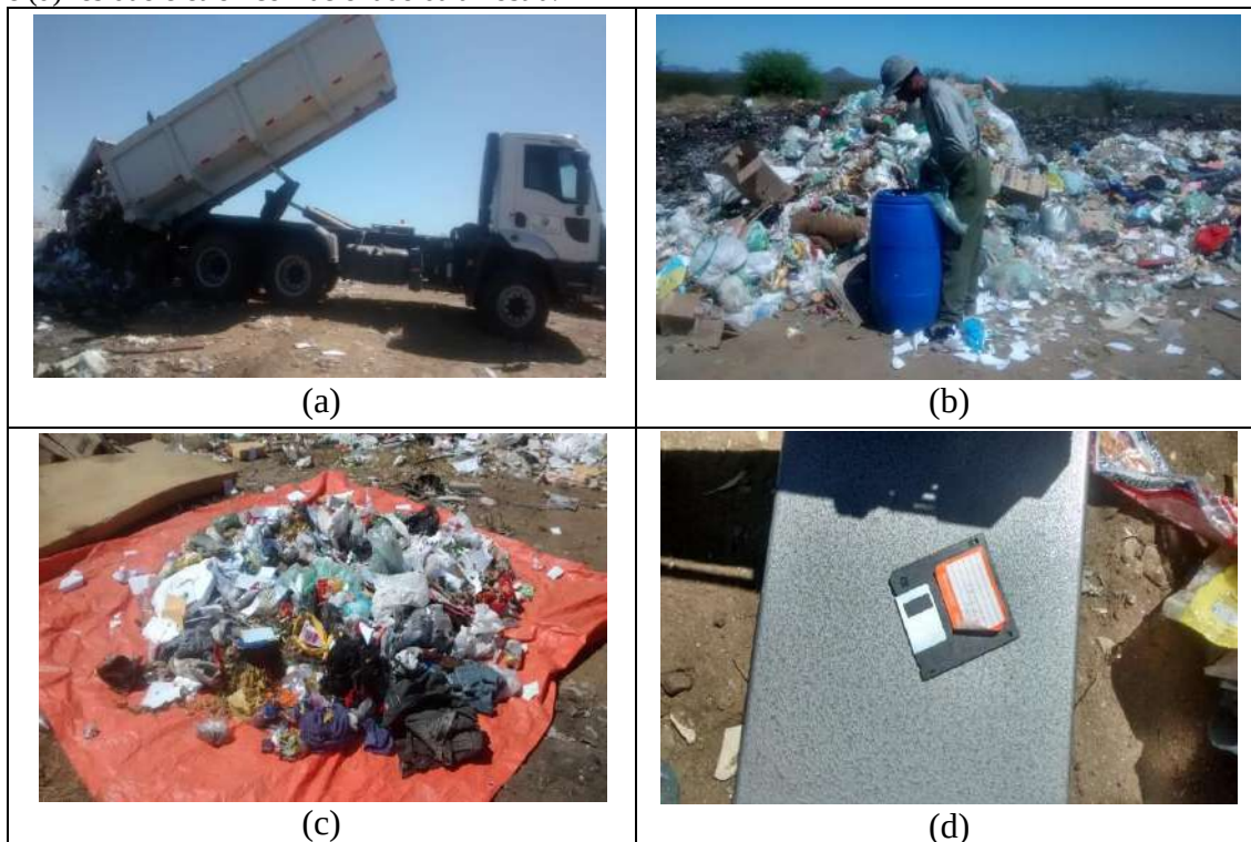
Figura 3.89 - Procedimentos de caracterização física dos resíduos sólidos em Timbaúba dos Batistas, (a) descarga dos resíduos no lixão, (b) amostra sendo coletada (c) massa de resíduos selecionada para o ensaio e (d) resíduo eletrônico fracionado da amostra.
