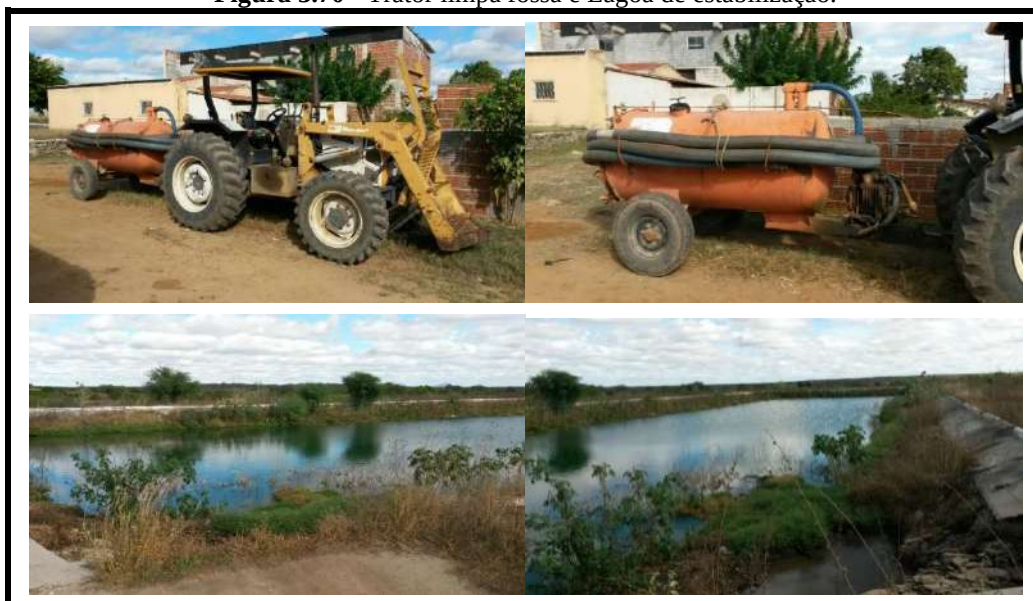
Figura 3.70 - Trator limpa fossa e Lagoa de estabilização.
